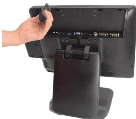
3. Привинчиваем кабель монитора покупателя 12" или 9.7", устанавливаем дисплей на моноблок
