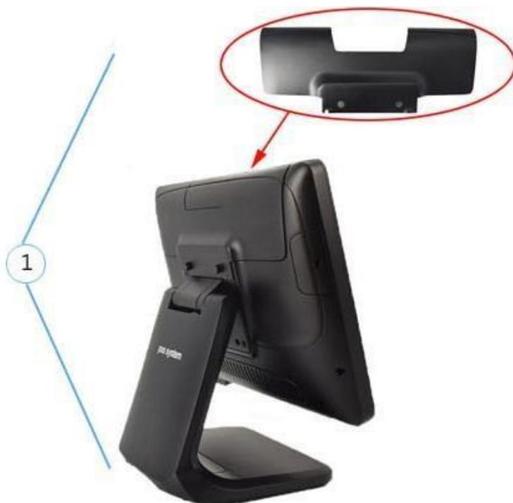
2. Снимаем металлическую пластину
