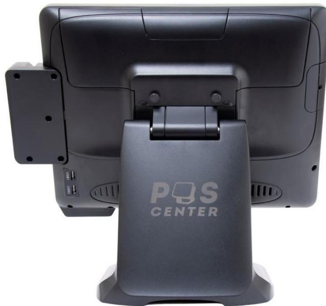
2USB-разъема вынесено на заднюю панель для быстрого доступа
