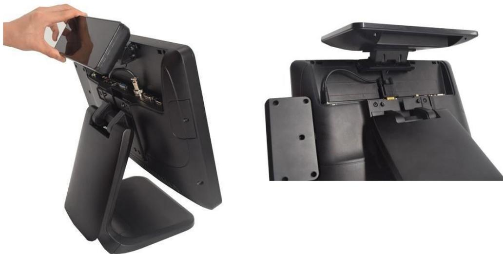
5. Устанавливаем и привинчиваем 2 болтами интерфейсную крышку
