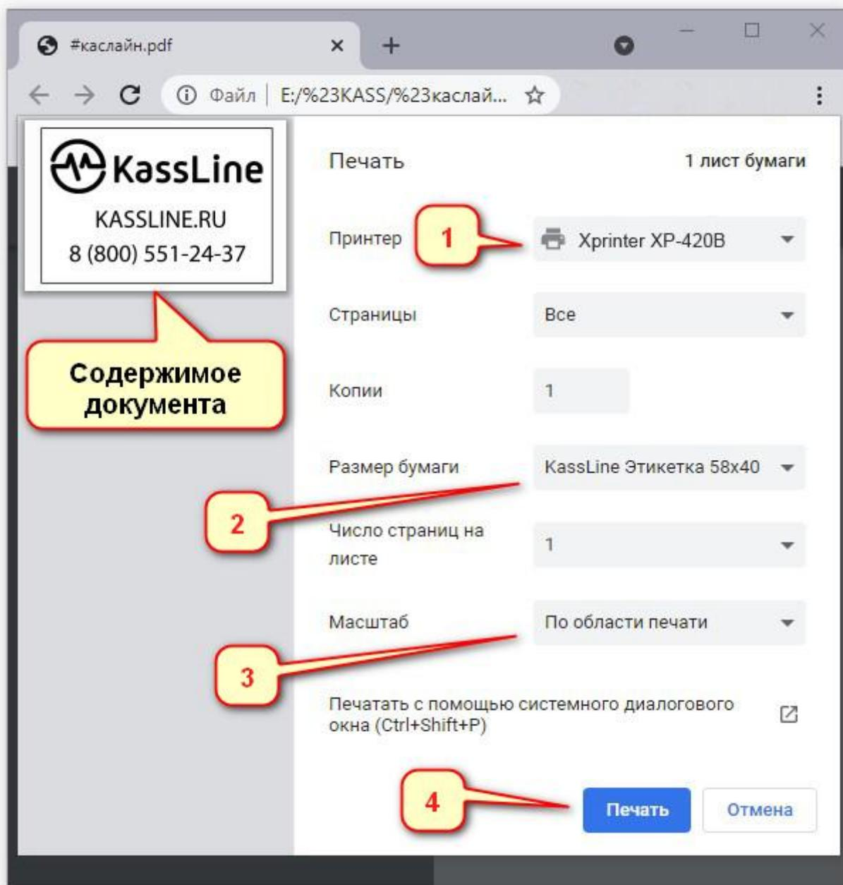
1. В списке установленных принтеров выберите Xprinter XP-420B /XP-460B
